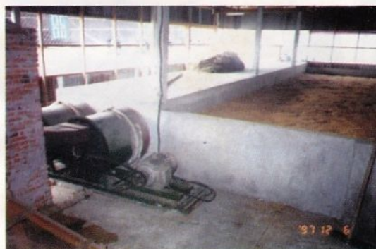
Máy sấy tĩnh vì ngang SHG-8 (8 tấn/mẻ)
