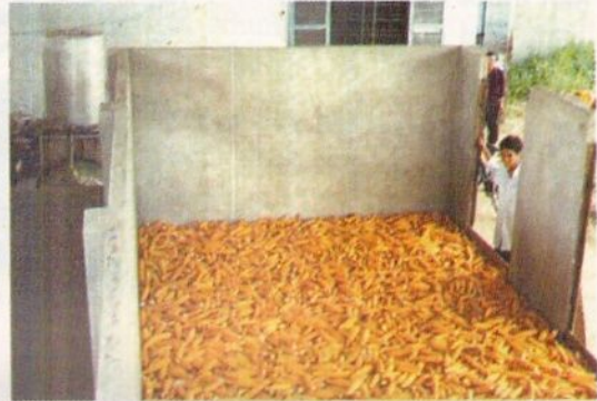
Máy sấy SHG-4 với vách buồng sấy cao, sấy bắp trái
