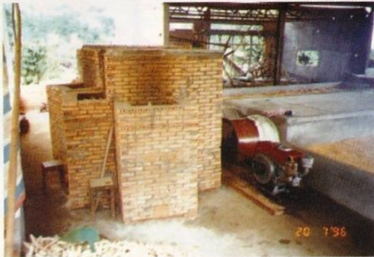
Máy sấy SHG-4 với lò đốt ngược, sấy bắp
