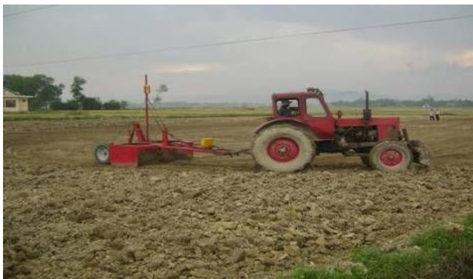
Hình 3. San phẳng đồng ruộng bằng laser tại Trại giống lúa Nam Vinh, Công ty cổ phần Giống cây trồng-vật nuôi Thừa Thiên Huế, tháng 5-2010
