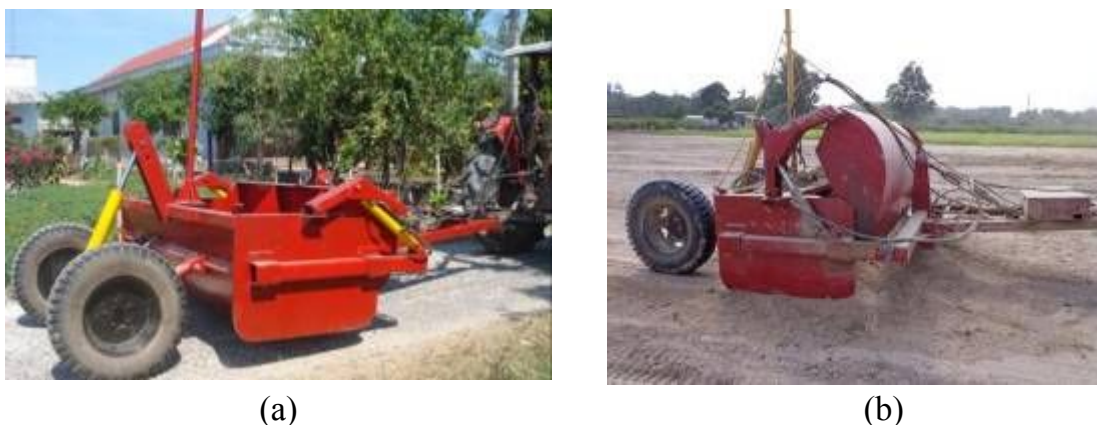
Hình 23. Gàu san sau khi được thiết kế, cải tiến
