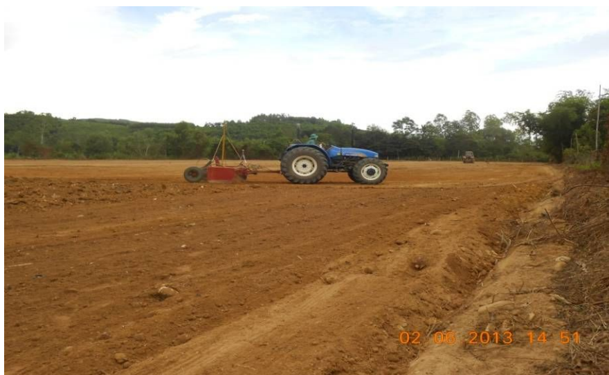
Hình 5. San phẳng đồng ruộng ứng dụng kỹ thuật laser tại huyện Nghĩa Hành, tỉnh Quảng Ngãi, tháng 6-2013
