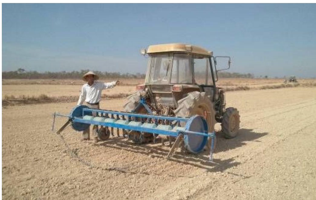
Hình 6. Thiết bị sạ khô ứng dụng trên đồng ruộng đã san phẳng điều khiển bằng tia laser
