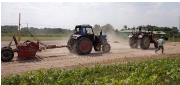
Hình 24. Thí nghiệm đo lực cản kéo
