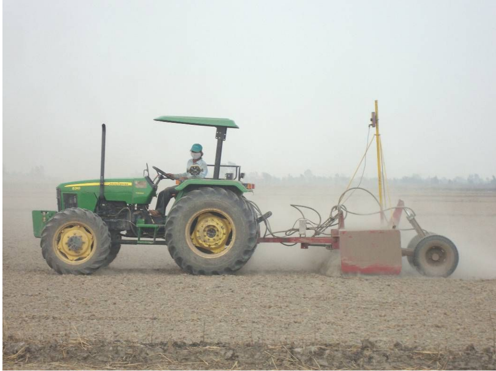
Hình 2: Máy san phẳng bằng laser của Trung tâm Khuyến nông đang hoạt động tại Mộc Hoá
