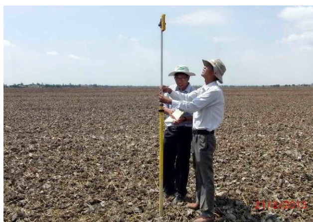
Hình 4: Đo đạc cao độ để tính khối lượng đất đào-dắp khi san laser
