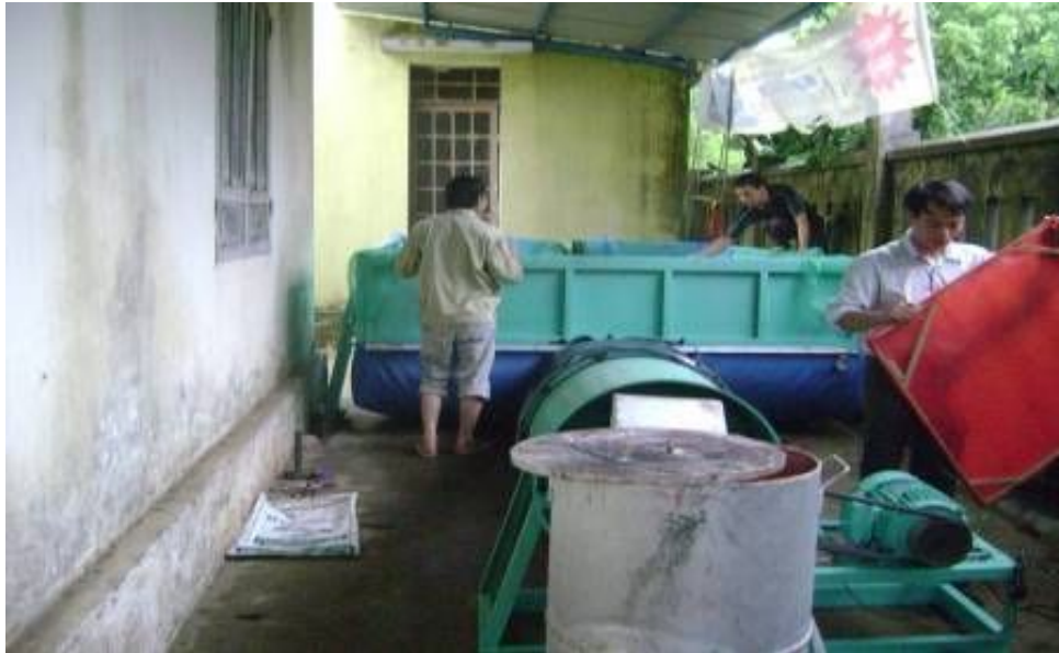
Hình 4. Máy sấy tĩnh vĩ ngang 2 tấn/mẻ của Công ty Hưng Trung Việt lắp đặt tại huyện Phú Ninh, Quảng Nam, tháng 9-2011
