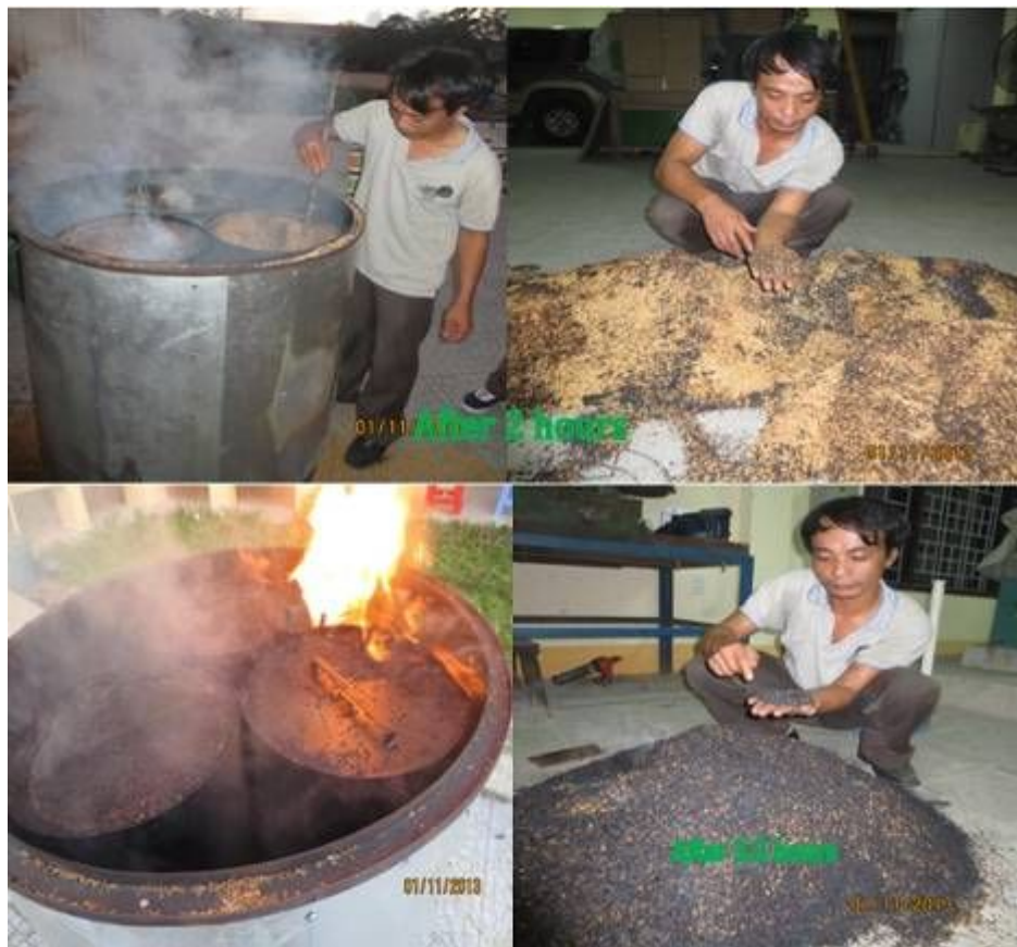
Hình 7. Một số hình ảnh khảo nghiệm hoạt động lò đốt trấu sản xuất Biochar thành phố Huế, tháng 11-2013
