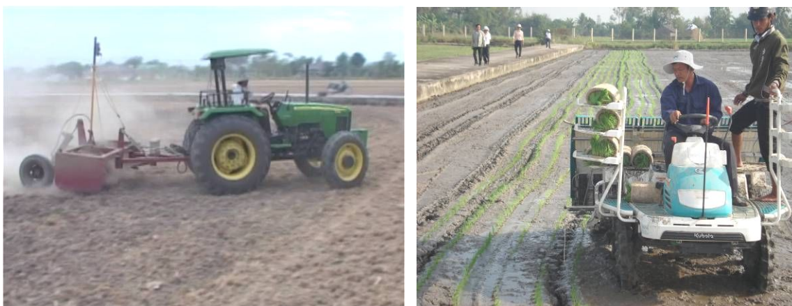
Hình 1. Kết hợp giữa san phẳng mặt ruộng bằng laser với máy cấy tại Trại lúa giống Hoà Phú - Long An
