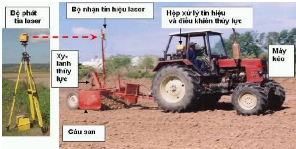
Hình 2. Liên hợp máy san phẳng laser và máy kéo MTZ-892 (110 HP).
