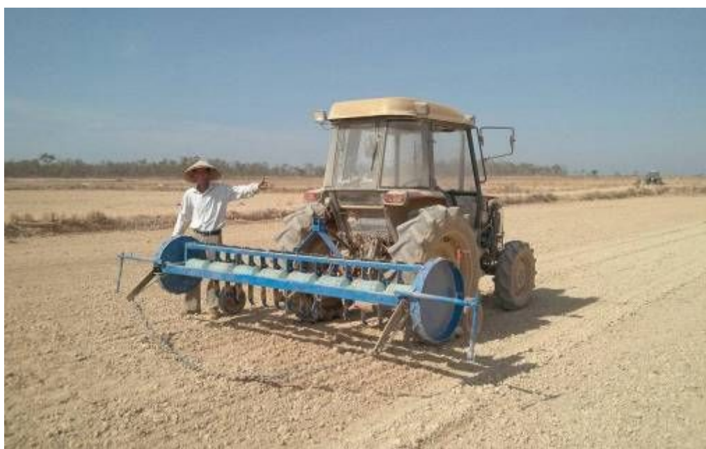
Hình 9: Thiết bị sạ khô ứng dụng trên đồng ruộng đã san phẳng điều khiển bằng tia laser
