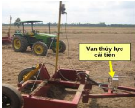
Hình 11: Cụm van thủy lực cải tiến được lắp đặt trên hệ thống san phẳng tại Long An và An Giang
