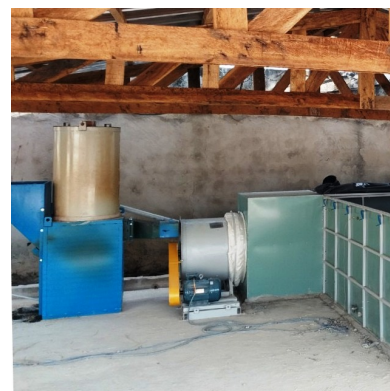
P1c. Lò đốt hình trụ, ghi nghiêng, Côte d’Ivoire 2023 Nguồn: FB Máy sấy Nông Lâm
