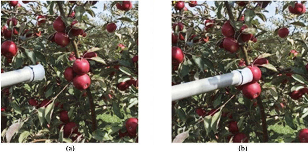
Hình 3. Ống chân không và tay thao tác cuối: (a) tiến gần để trái cây; (b) giữ chặt trái cây.
