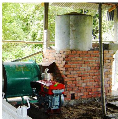
P1b. Lò đốt trấu hình trụ, ghi nghiêng, Việt Nam 2006 Photo: PHHien
