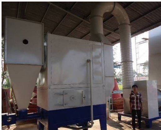
Hình 6 và 7. Lò đốt trấu tự động và sơ đồ nguyên lý
