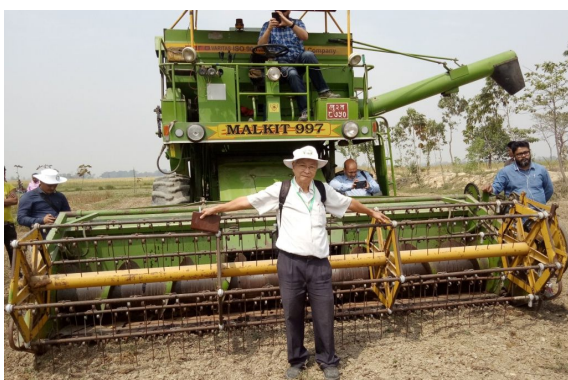
(a) Máy GDLH Malkit 997, bề rộng cắt 4,5 m
