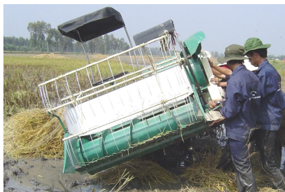
Hình 10. Máy GDLH mini, 4 người có thể nâng một bên máy để thay bánh cho phù hợp
