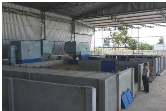
Hình 10. Hai máy sấy lúa SRA-10, lò đốt tự động, Bà Rịa Vũng Tàu, 2015. (Photo: TVTuấn)
