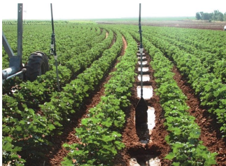
Hình 4. Hệ thống tưới LEPA cho bông vải, ở Trung tâm thực nghiệm Đại học Texas A&M.
