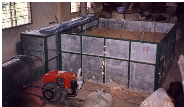
Hình 2. Nguyên lý và cấu tạo máy sấy đảo chiều gió SRA-1.5
