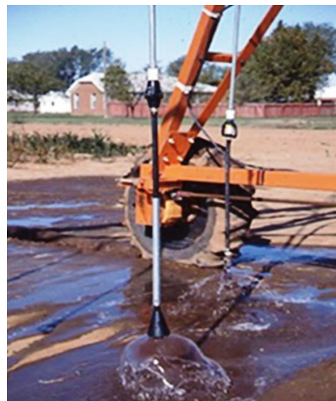
Hình 3. Đầu tưới cho LEPA do Cty Rainbird sản xuất vào thập niên 1980.
