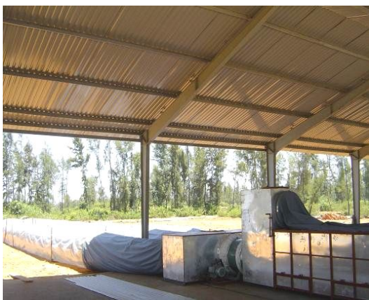
Hình 7. Máy sấy khoai mì xắt lát SRA-5, kết hợp sử dụng NLMT, Quảng Nam, 2008. (Photo: LQVinh)
