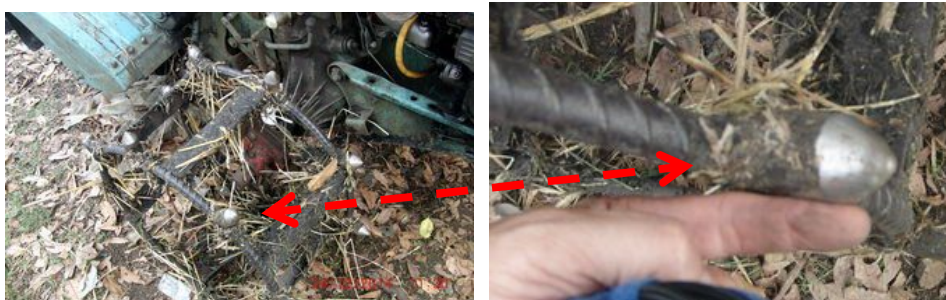
Hình 4. Mẫu hàn trên bánh máy kéo để tạo lỗ gieo
