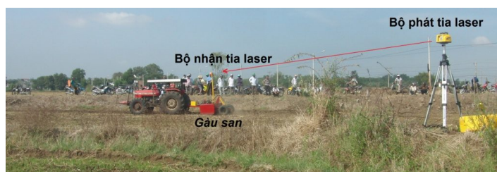
Hình 14. Máy san phẳng ruộng điều khiển bằng tia laser (Bà-Rịa Vũng Tàu, 2014)
