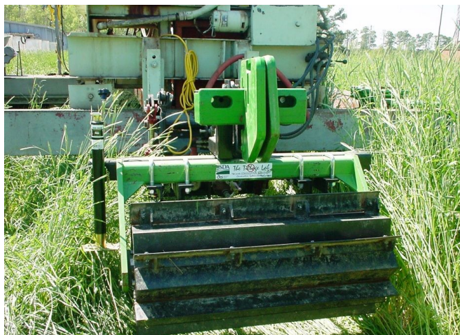
Hình 1. Trục lăn cho thí nghiệm 1; để ý đến các lưới gắn trên trục, và thanh thép chữ L giữa các lưới.
