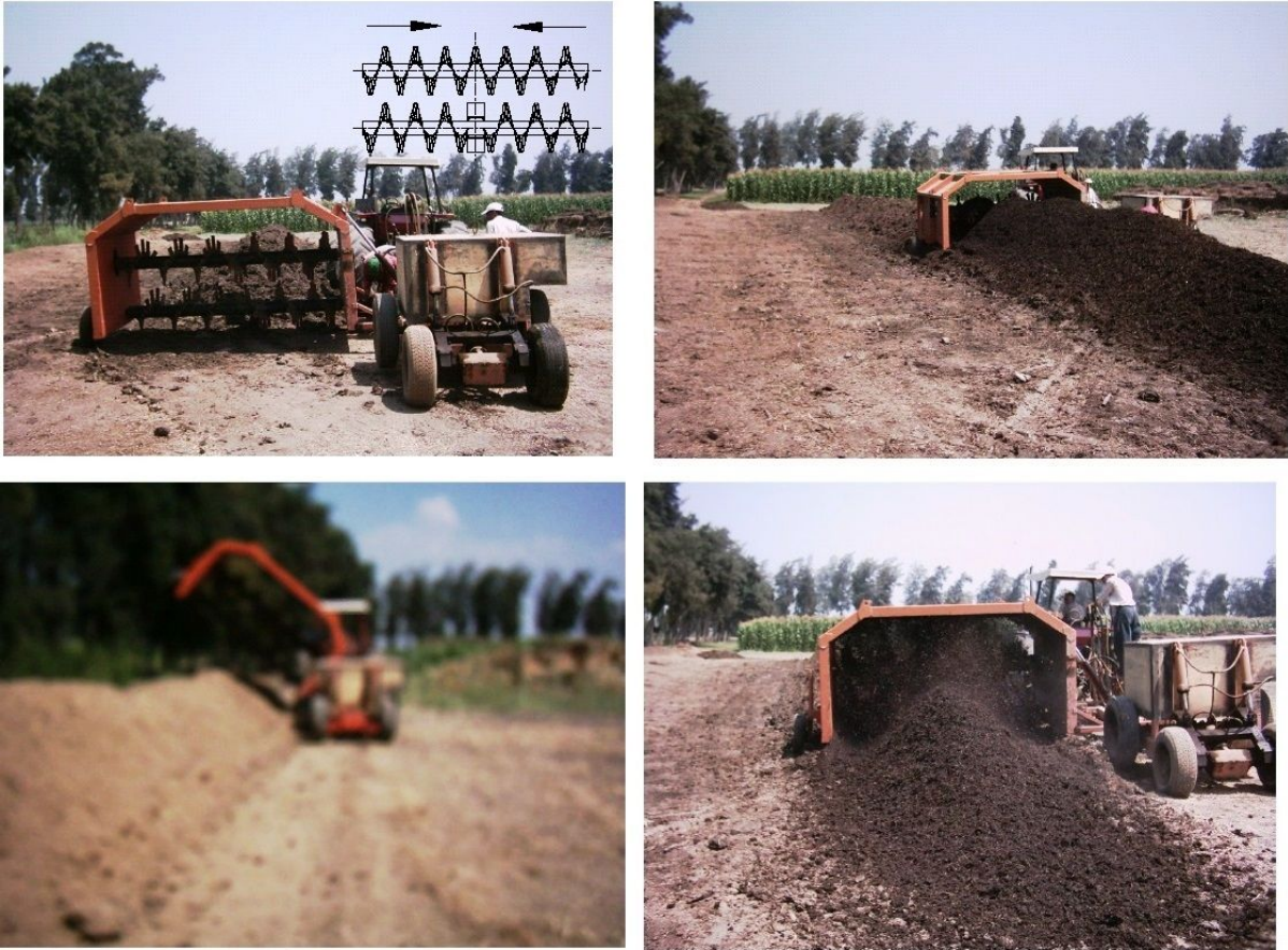
Hình 4. Hoạt động của máy đảo trộn phân ủ
